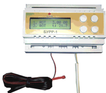
Базовый блок БУРР-1 (показан ИК-приемник для настройки системы)
